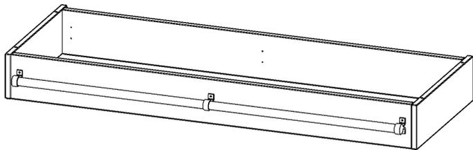
Bei einer Leiterzarge handelt es sich um ein Zwischenstück, welches ähnlich wie ein Socket gebaut wird. Die Höhe der Leiterzarge beträgt 15 cm. An der Zarge wird ein Aluminiumrohr mittels entsprechenden Halterungen so montiert, dass die jeweils passenden Einhängelaternen sicher eingehängt werden können.
