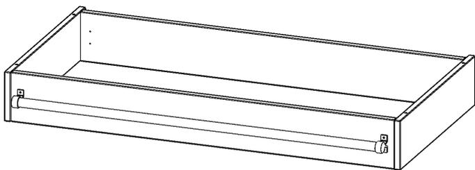
Bei einer Leiterzarge handelt es sich um ein Zwischenstück, welches ähnlich wie ein Socket gebaut wird. Die Höhe der Leiterzarge beträgt 15 cm. An der Zarge wird ein Aluminiumrohr mittels entsprechenden Halterungen so montiert, dass die jeweils passenden Einhängelaternen sicher eingehängt werden können.
