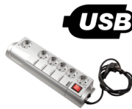
Programmierbare Steckdosenleiste mit USB-Schnittstelle
